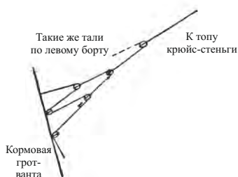
Рис. 131. Английский крюйс-стенъ-штаг примерно 1620 года
