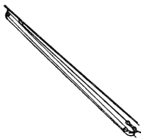
Рис. 345. Фал стакселя, крепящийся под леером
