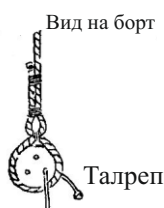
Рис. 88. Расположение талрепа относительно конца ванты
