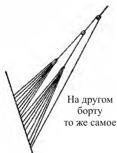
Рис. 135. Крюйс-стенъ-штаг французского судна голландской постройки 1626 года
