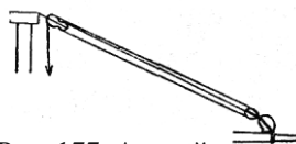
Рис. 177. Английские 3-составные топенанты нижнего рея примерно 1715 года
