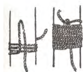
Рис. 13. Способ уста- новки вулинга на мачту
