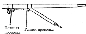
Рис. 197. Проводка нижних гитовых
