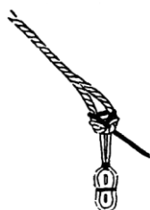
Рис. 112. Соединение шкентеля, блока и оттяжки штаг-талей
