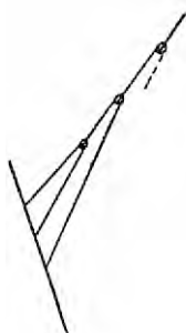
Рис. 136. Голландский крюйс-стенъ-штаг примерно 1660 года
