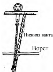
Рис. 124. Способ крепления путенс-вант
