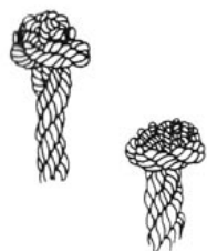
Стопорные кнопки на конце пертуля
