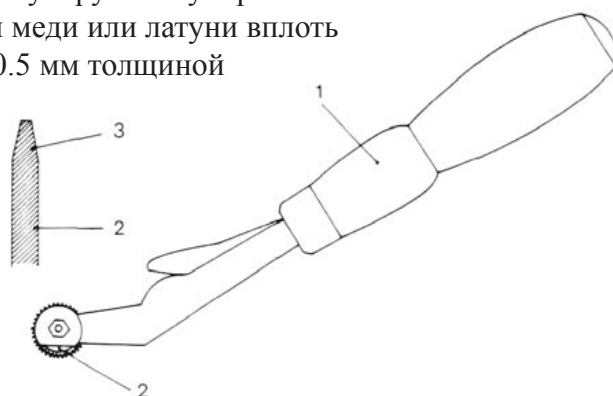
Колесико для тиснения гвоздей: 1. Рукоять; 2. Копир для края; 3. Заточка краев копира. Для меди и латуни вплоть до 0.1 мм толщиной.
