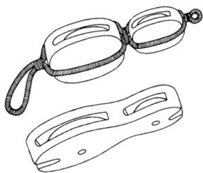
Лонг-такель-блок: сверху английский, снизу континентальный.
