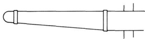
Адмиральский якорь с дубовым штоком 18-19 века. Обратите внимание на щель между двумя брусами и использование железных бугелей.
