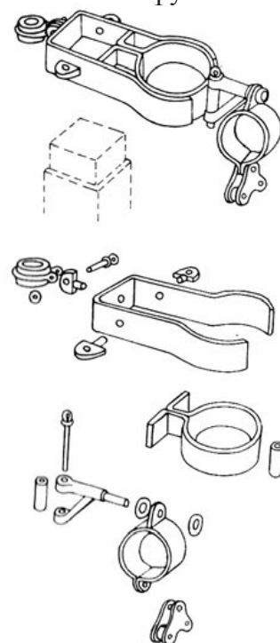
Нижний рей и нижний марса-рей с середины 19 века (в несколько упрощённом виде для модели):
