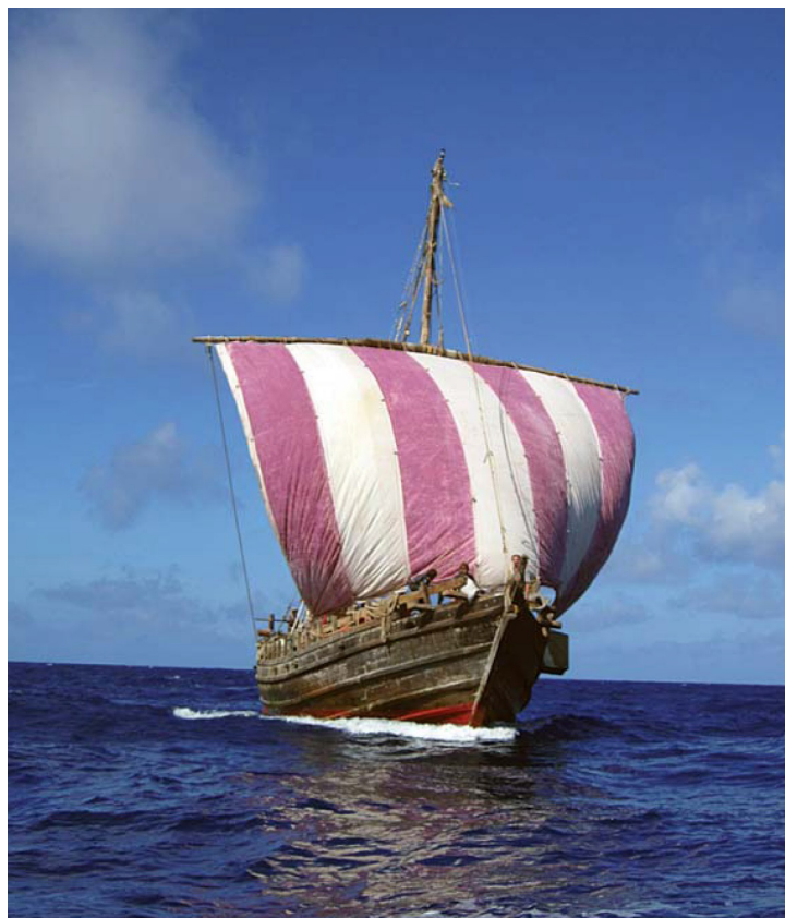
Реплика финикийского корабля Phoenicia под парусом. Парус окрашен финикийским пурпуром, красителем, добываемым из моллюсков, прославившего Финикию на весь древний мир. Видны фалы, используемые для поднятия и спуска паруса, штаг (соединяющего топ мачты и нос) и частично бакштаг. (Фото приводится с разрешения Phoenicia.org)
