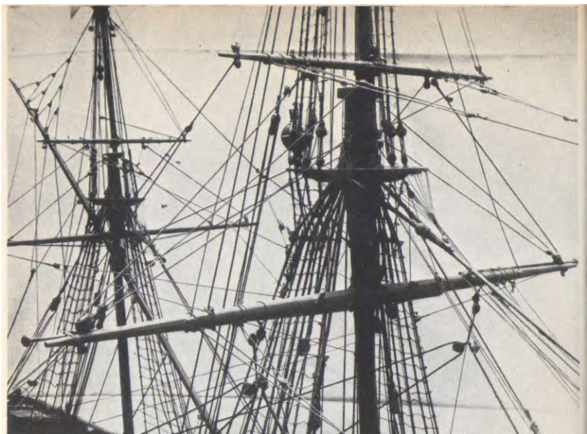
Фотография 4. Модель 70-пушечного корабля 1692 года - ГРОТ-МАЧТА И БИЗАНЬ-МАЧТА
